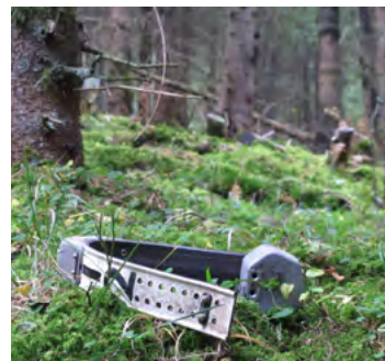
Die von uns eingesetzten GPS-Halsbänder liessen sich zeit- und ferngesteuert ablösen. Foto: Claudio Signer
