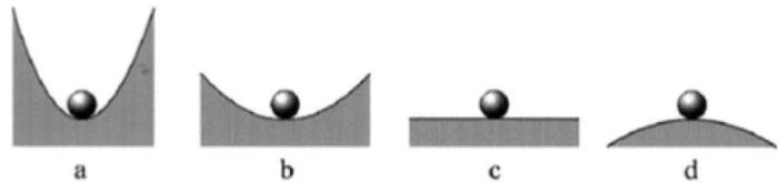
Abbildung 3: Stabilität am Beispiel Kugel und Schüssel. a ist die stabilste und d die instabilste Form. Die Schüssel zu vertiefen oder die Wände steiler zu machen erhöht die Fähigkeit der Kugel, Störungen zu widerstehen und somit die Stabilität. Nach McGill, 2001.
