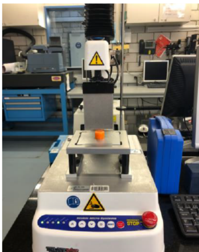
Abbildung 5: Texturmessung der Karotten. Links: Textur Analyser TA.XT Plus. Rechts: Karottenscheibe mit Durchmesser von 2 bis 3 cm und Schneidevorrichtung «Knife Edge».
