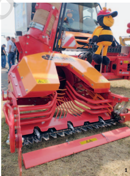
1 Dücker SGG Ökomähkopf mit Mähbalken, mechanischer Schnittgutaufnahme vor dem Absaugen und Tastwalze mit Verjüngungen.
