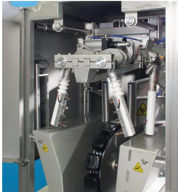
Abbildung 3: Vollautomatische Betäubungsanlage für Schweine mit Brustbandrestrainer und Elektroden (Elektrisches Betäubungssystem, Midas, 2023)
