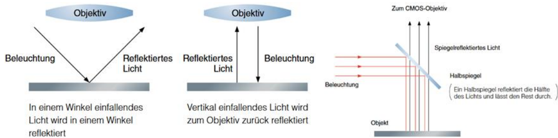
Abbildung 16: Funktionsweise der Koaxialbeleuchtung (Keyence Corporation, 2019).
