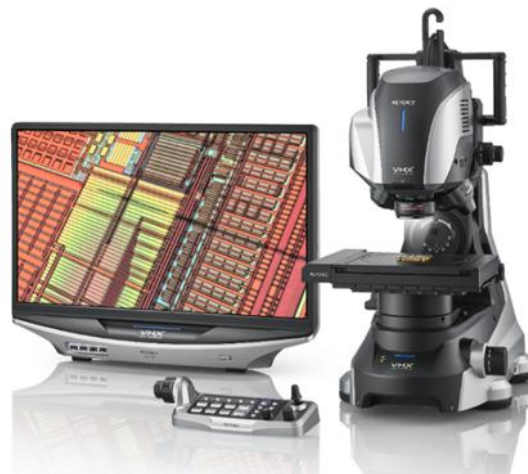
Abbildung 20: Digitalmikroskop VHX-7000 mit Monitor und Konsole (Keyence Corporation, 2020).
