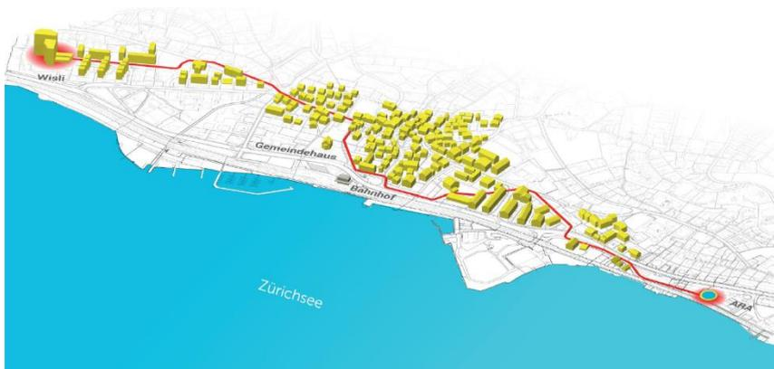
Abbildung 14: Geplantes Niedrigtemperaturnetz der Gemeinde Richterswil. Eingespeist wird die Wärme u.a. von der ARA und vom Seewasser des Zürichsees. 2023 Entscheidet das Stimmvolk über die Errichtung (Gemeinde Richterswil, o. J.).
