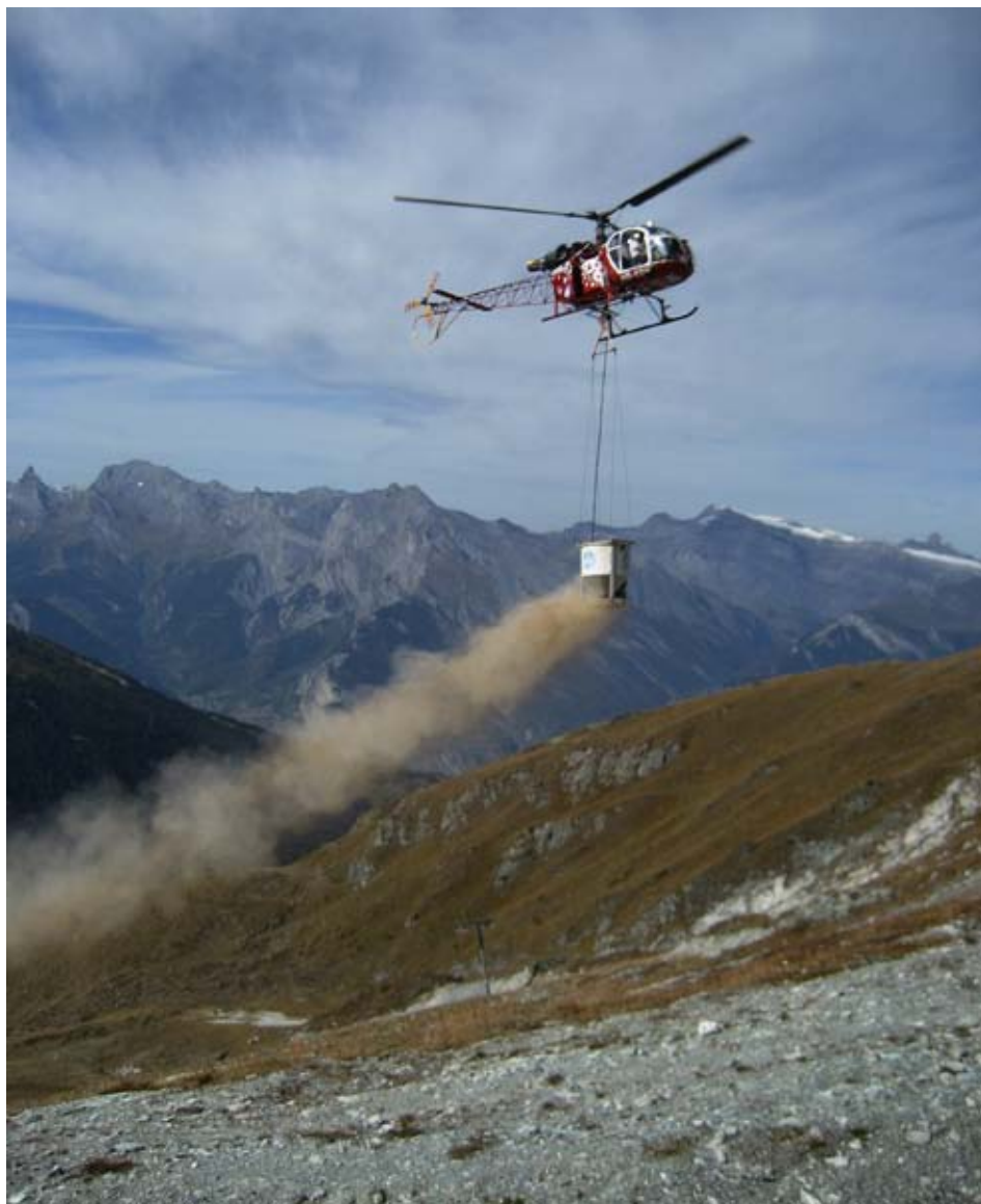
Helikopter mit Saatgerät im Einsatz (Bild: M. Schwager)
