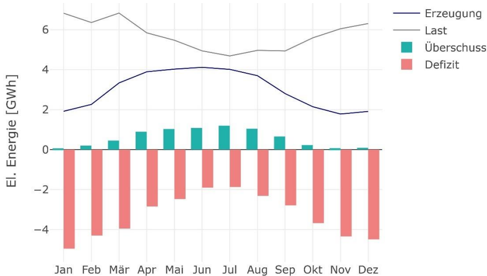
Abbildung 23: Monatlicher Verlauf von Erzeugung, Last, Überschüssen und Defiziten in GWh
