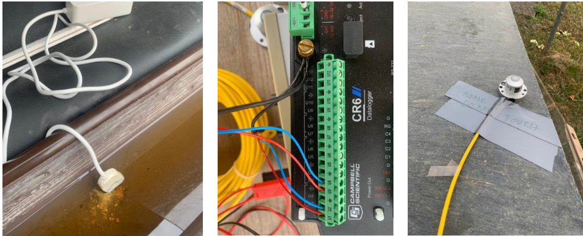
Abbildung 11: Von links nach rechts: Aufgelöster WLAN-Wassermelder, Datenlogger des Pyranometers und Sensor für Sonneneinstrahlung.
