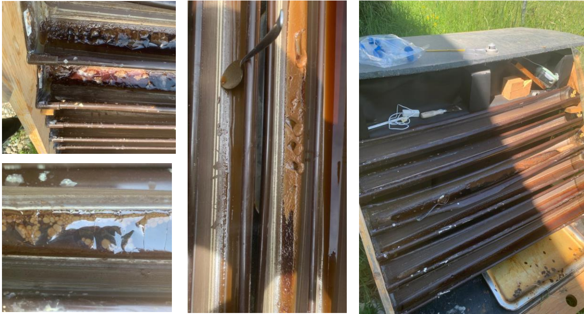
Abbildung 28: Von links nach rechts: Nährstoffschicht auf dem Urin; Zähflüssige Brühe; Verbogene Rinnen.
