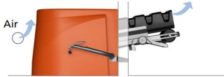
Abbildung 3: Ecodomeo Trockentrenntoilette mit Förderband. Bild von www.kompotoi.ch
