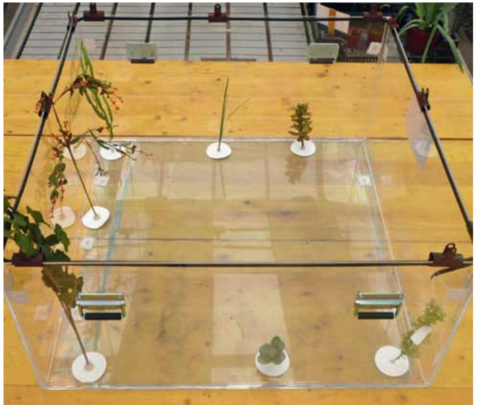
Zeckenterrarium mit künstlicher Bepflanzung und Heizkabel als Fluchtbarriere.
