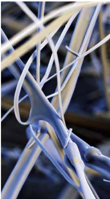
Titandioxid-Nanofasern im Elektronenmikroskop bei 3500-facher Vergrösserung. © 2010 eye of science und ZHAW ICBC.
